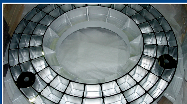
Облегченное зеркало диаметром 1 м с облегчением до 70% Light weighted mirror with diameter 1m with light weight rate up to 70%
