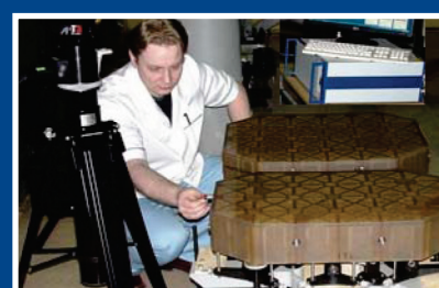
Юстировка оптических элементов с внеосевой асферикой с использованием гексапода и лазерного трекера APIT3 Off-axis aspherical optical elements adjustment by means of hexapod and laser tracker APIT3
