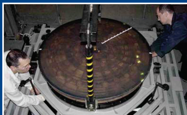
Установка узла вторичного зеркала в вертикальный стенд контроля со сферой Хиндла Installation of Secondary mirror assembly into vertical the test bench with Hindle sphere
