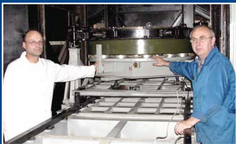
Контроль линзы Физо со сферическим эталонным зеркалом (Ø1200 мм) Fizeau lens testing with the spherical reference mirror (Ø1200 mm)
