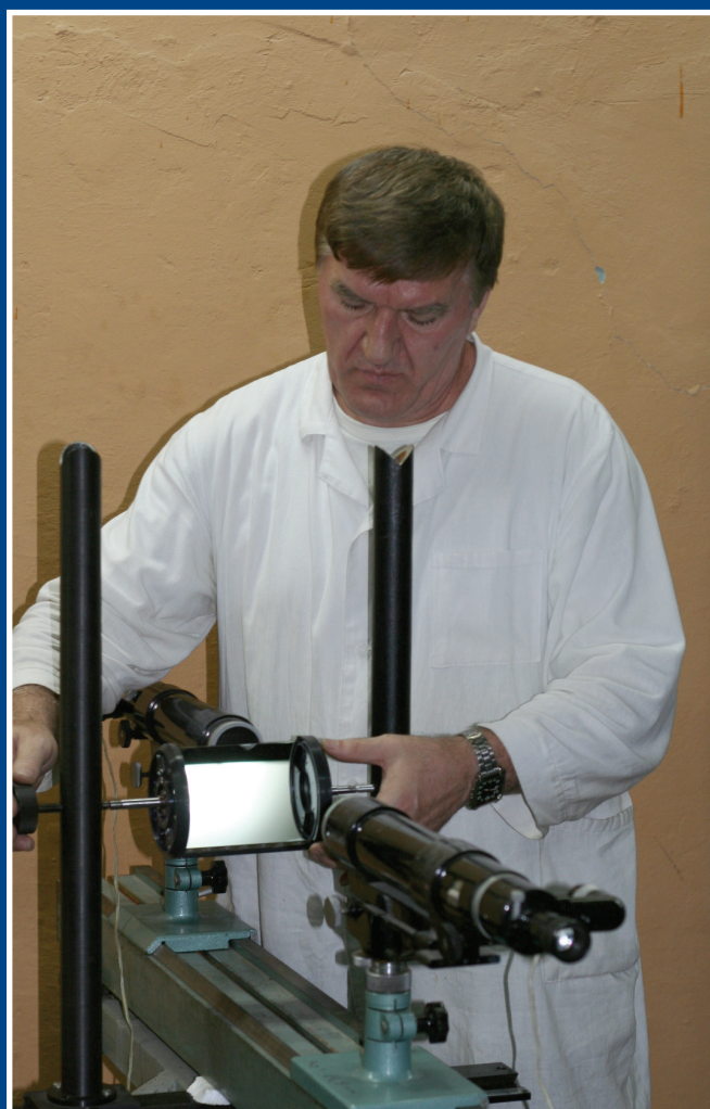
Юстировка сканирующего зеркала для спутника «Электро-Л» Scanning mirror adjustment for “Electro-L” satellite
