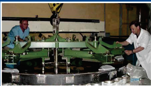
Установка зеркала телескопа VST на технологическую оправу Installation of VST telescope mirror on technological cell
