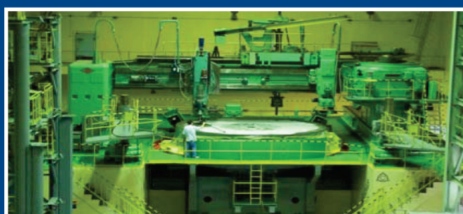
Процесс шлифовки и полировки зеркала БТА BTA mirror grinding and polishing process
