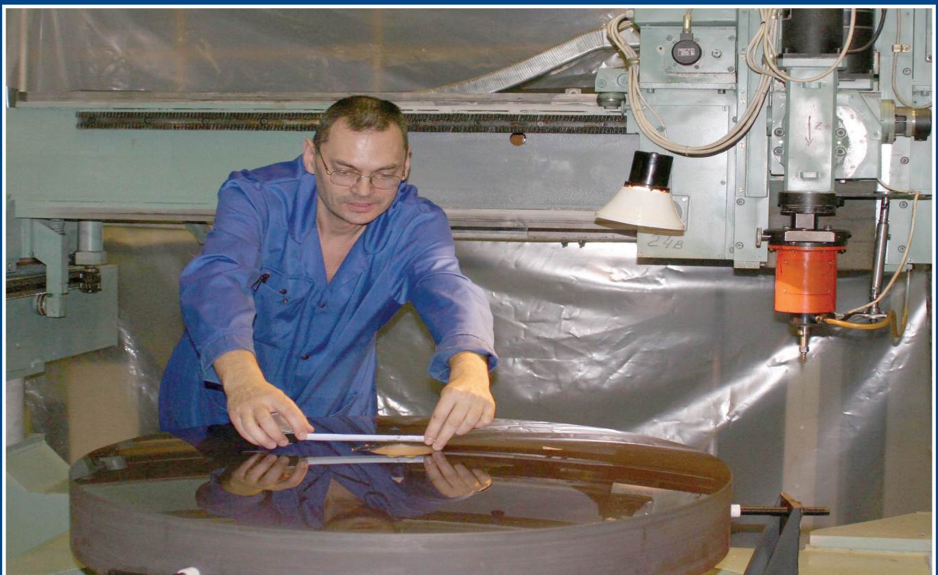
Станок СД-1000 для финишной доводки зеркал диаметром до 1.3м CD-1000 CNC machine for final polishing of mirrors up to diam.1.3m
