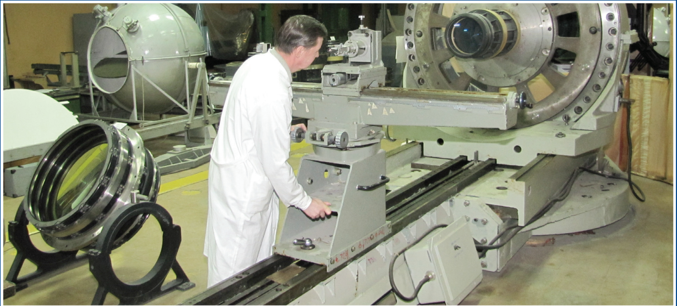
Оптическая скамья ЮСКБ-77 для контроля КГЛО Testing bench Yu.SKB-77 for testing of large-size objective lenses
