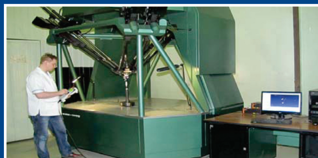
Машина 3D КИМ-1400 для измерения формы поверхности зеркала или линзы 3D Device KIM-1400 for testing of mirror/ lens surface
