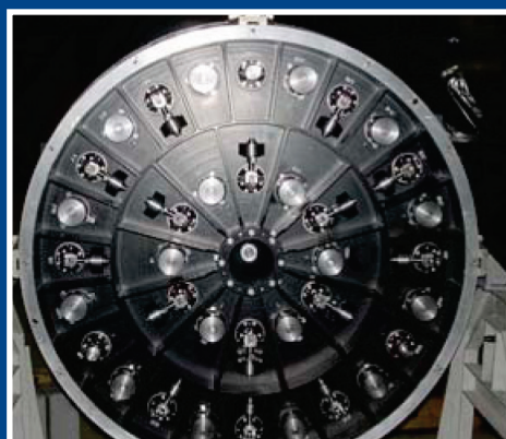
Установка узла вторичного зеркала в вертикальный стенд контроля со сферой Хиндла Installation of Secondary mirror assembly into vertical the test bench with Hindle sphere
