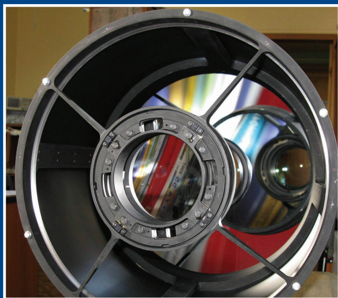
Объектив КМ-120 для наземного комплекса слежения KM-120 objective for ground base complex of tracking guidance system
