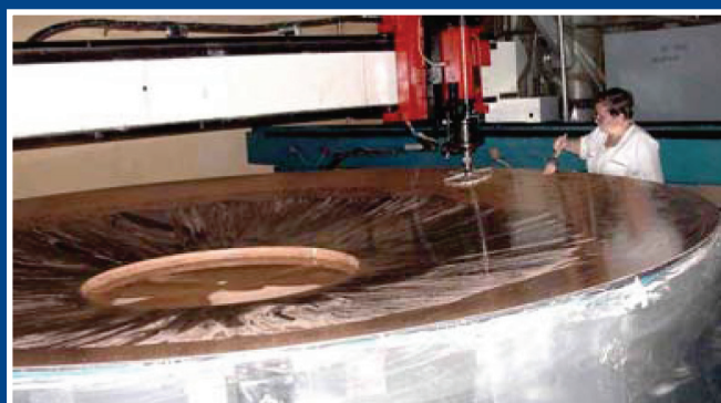
Полировка главного зеркала с компьютерным управлением Primary mirror polishing on computer-controlled machine
