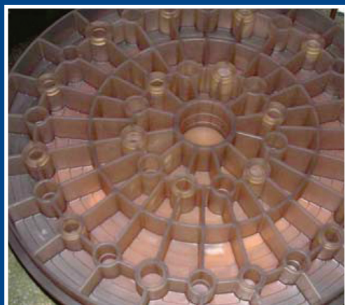
Общий вид облегченного зеркала General view of light weighted mirror
