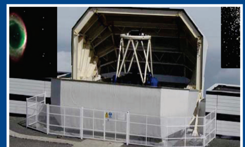
Роботизированные телескопы диаметром 2050 мм с зеркалами ЛЗОС Robotic telescopes with the mirrors diameter 2050mm using LZOS
