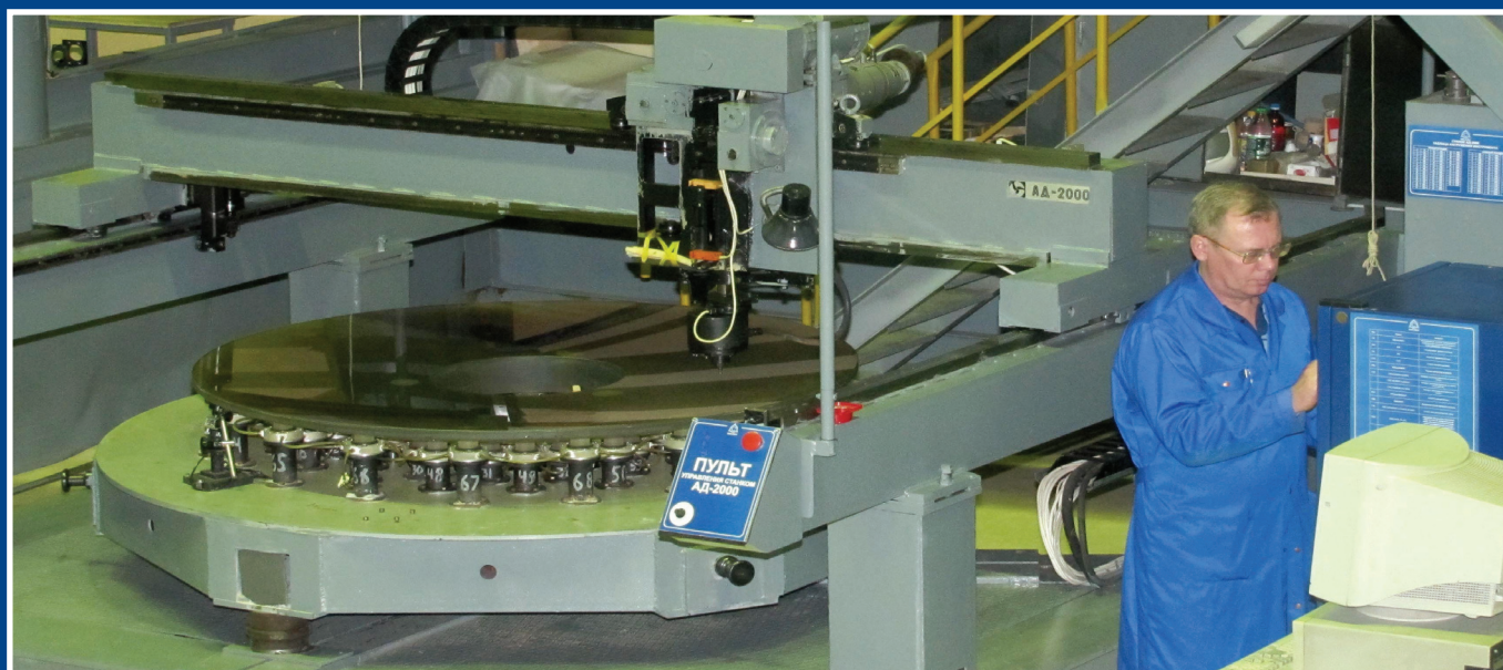
Процесс финишной полировки высокоточного зеркала на станке АД-2000, управляемом компьютером Final polishing of high-precision mirror on computer controlled polishing machine AD-2000
