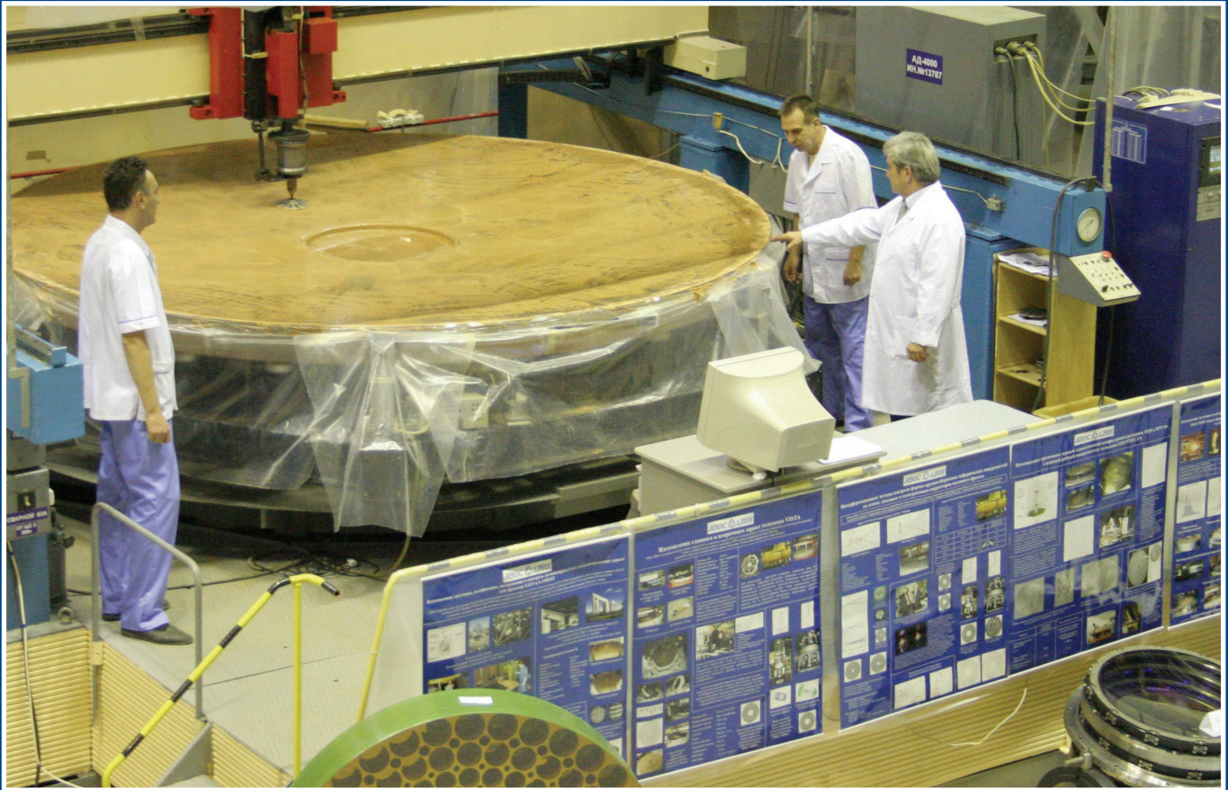
Финишная доводка зеркала диаметром 3.7м на станке АД-4000 Final polishing of \varnothing 3.7m mirror on AD-4000 CNC machine
