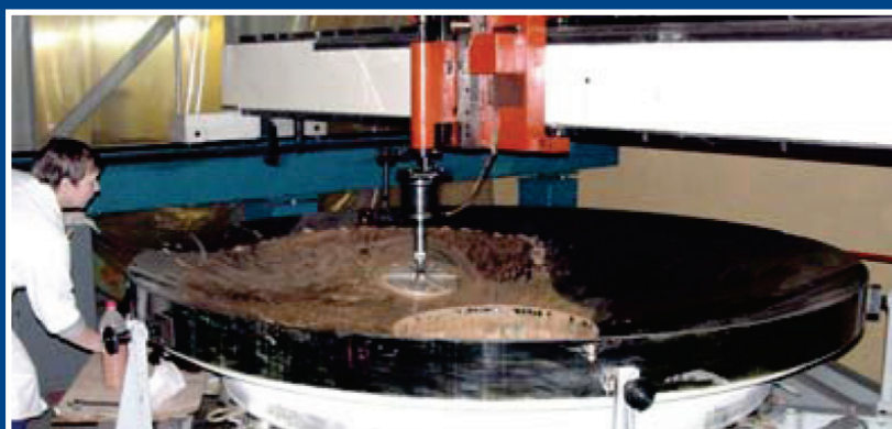
Обработка сферы Хиндла для контроля вторичного зеркала. Диаметр зеркала 2420 мм, радиус 2510 мм. Hindle sphere treatment for testing of the secondary mirror with diam. 2420mm and Radius 2510mm
