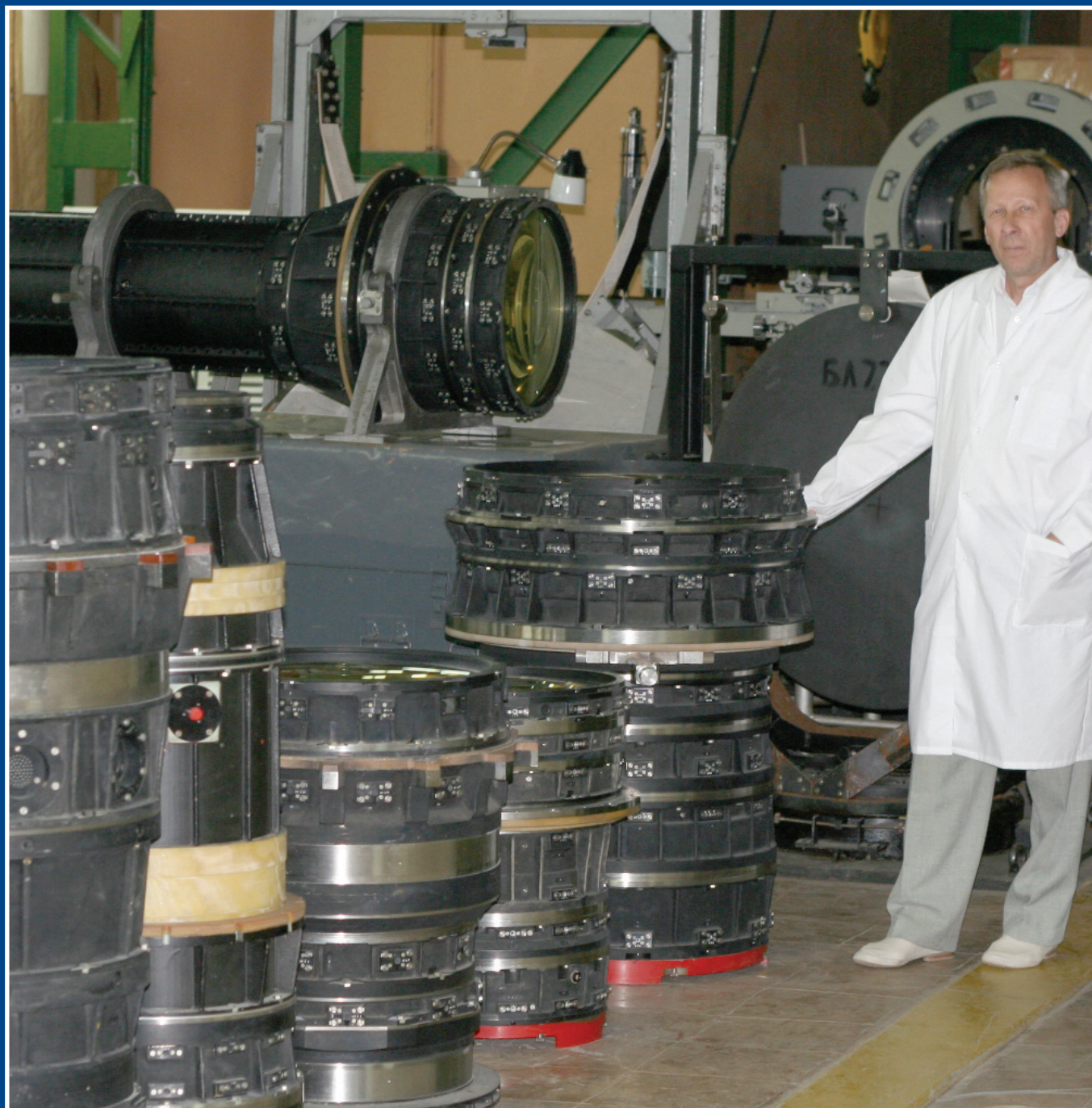
Крупногабаритные линзовые объективы для космической аппаратуры Large dimensions objective lenses for space facilities
