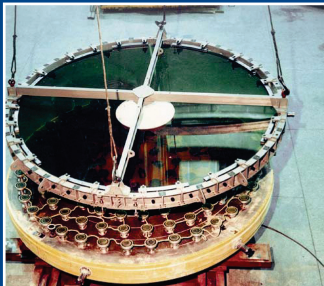
Установка тонкого адаптивного зеркала диаметром 3300 мм на технологическую оправу Installation of thin 3300 mm adaptive mirror on technological cell
