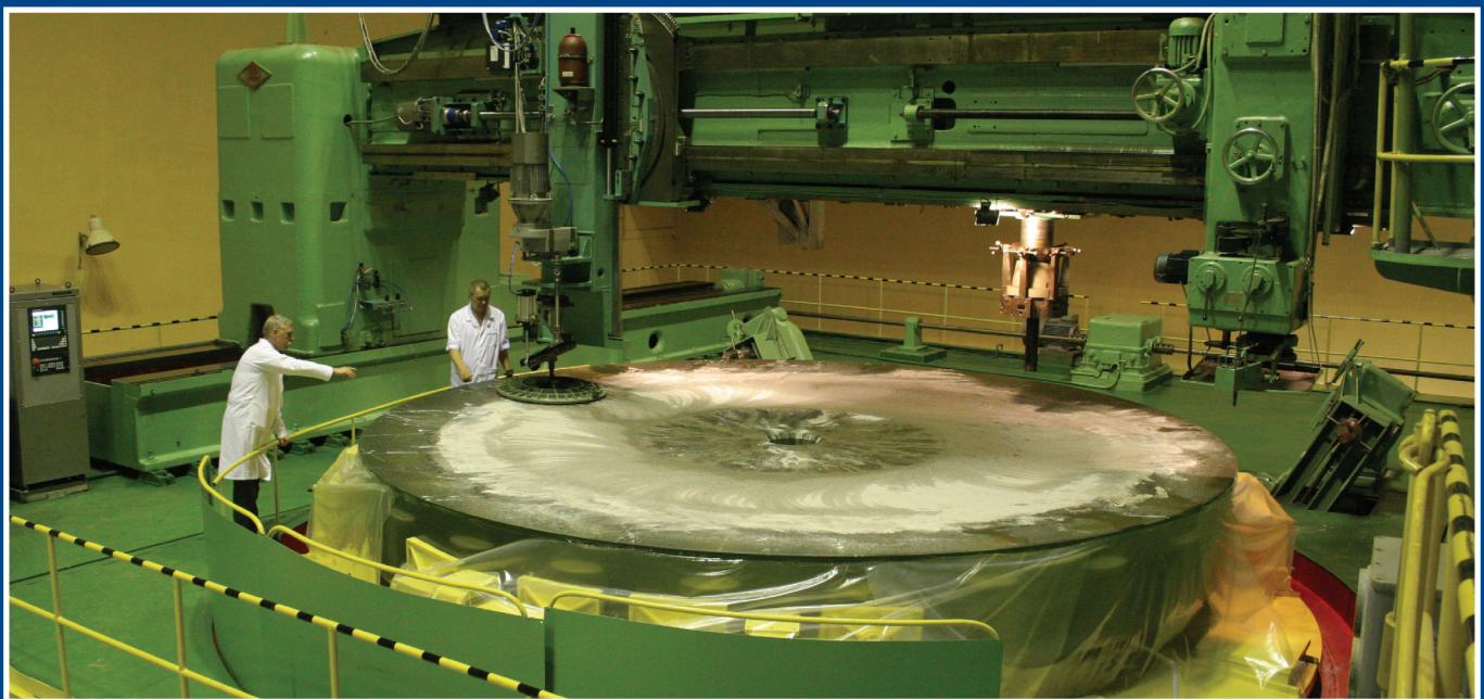
Процесс шлифовки зеркала диаметром 6 метров БТА на станке КУ-168АДМ Polishing of 6 m mirror for Bolshoi Azimuthal Telescope on polishing machine KU-168ADM
