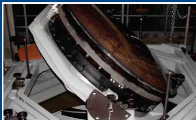
Установка узла вторичного зеркала в вертикальный стенд контроля со сферой Хиндла Installation of Secondary mirror assembly into vertical the test bench with Hindle sphere
