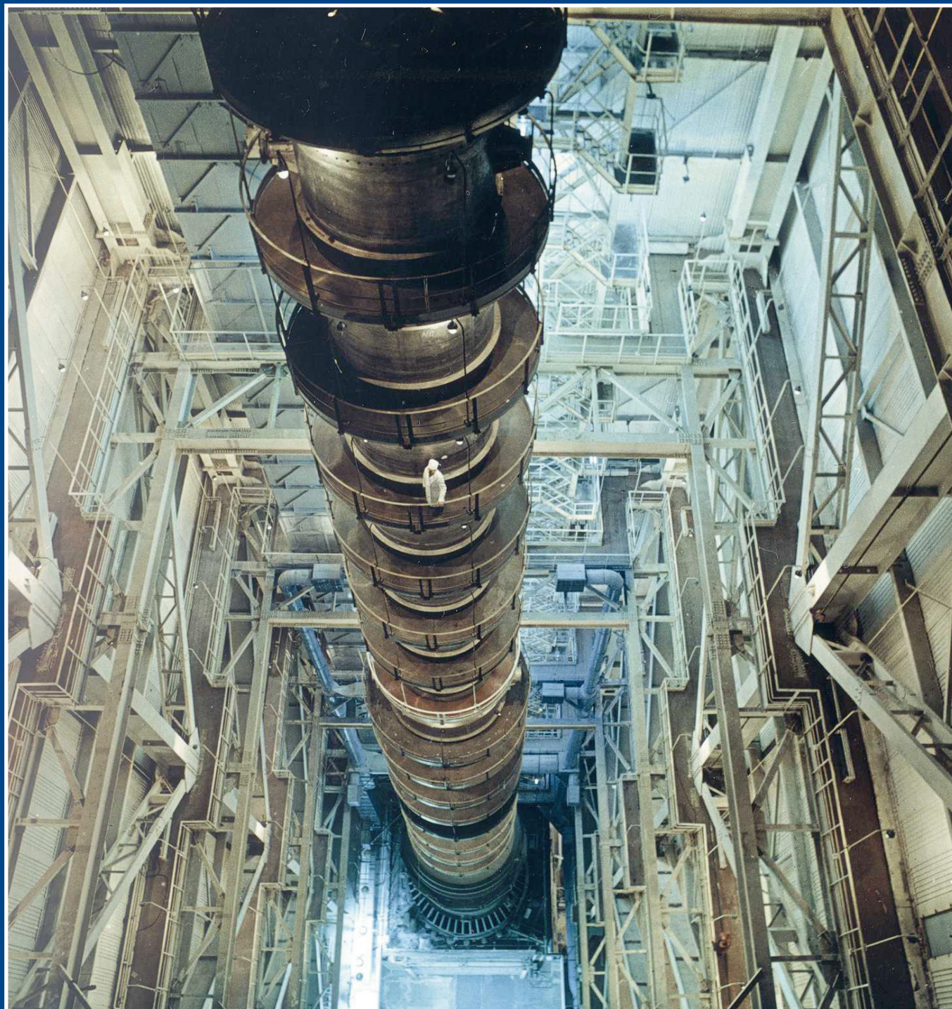
Вид испытательного стенда УВК-6/70 с вакуумированным оптическим трактом с площадки на высоте 72 метра View of the test set УВК-6/70 with evacuated optical path from the site on the height of 72 m
