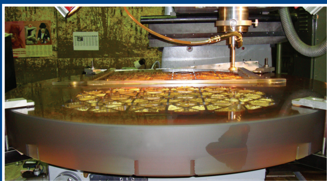
Фрезерование облегченной структуры Milling of light weighted structure
